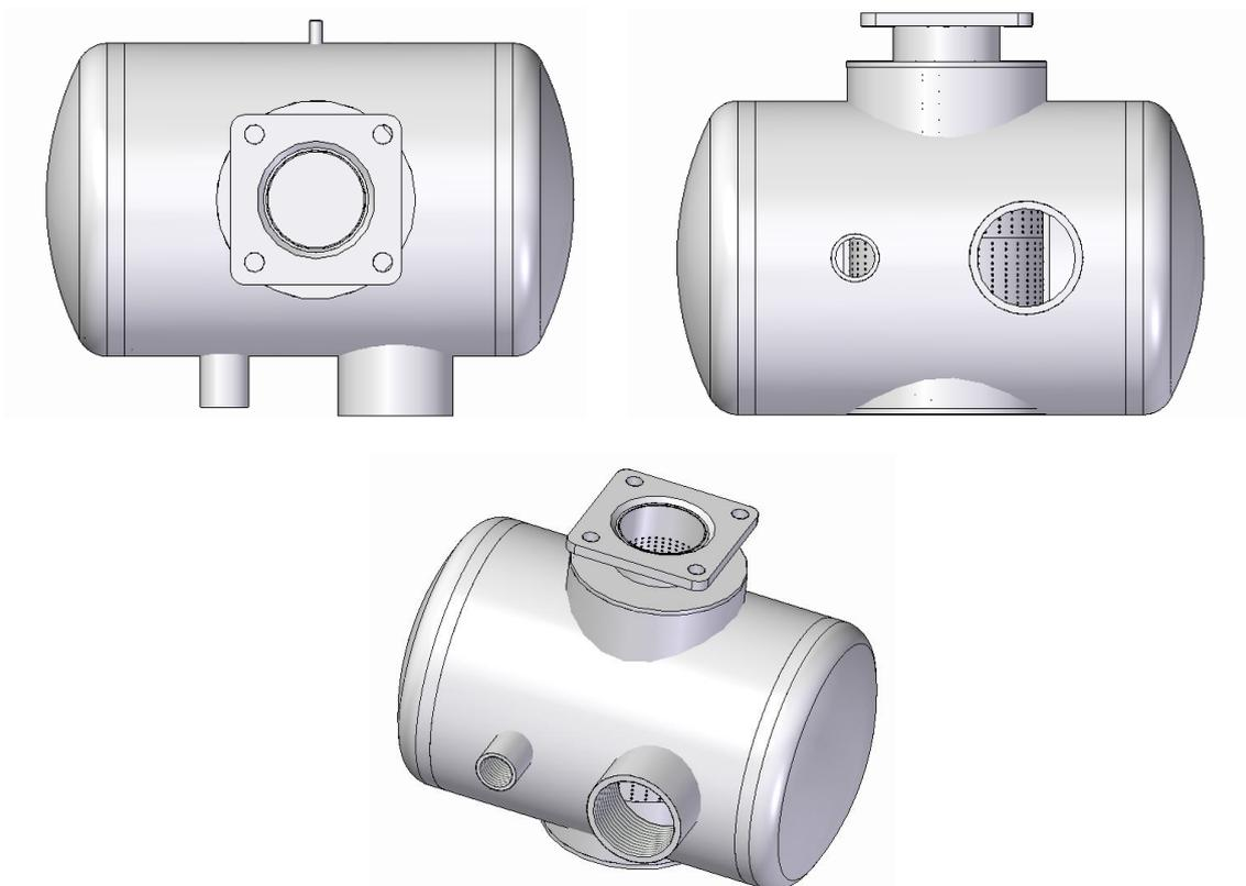
Figura 13. Diseño en CAD del silenciador de pulsaciones
