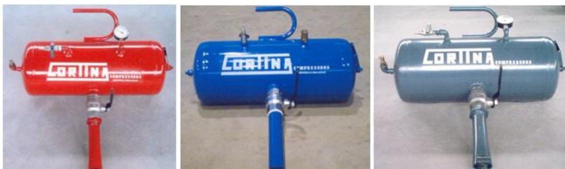
Figura 10. Talonador modelo Turboair CR-25, capacidad volumétrica 25 litros presión máxima de diseño 12bar con distintos acabados de pintura RAL.
