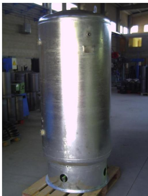
Figura 6. Depósitos acumuladores verticales de de acero al carbono con acabado galvanizado. La imagen izquierda muestra un modelo C-1000 vertical en conexión con un modelo C-50 horizontal. La imagen derecha muestra un modelo C-1000 vertical.
