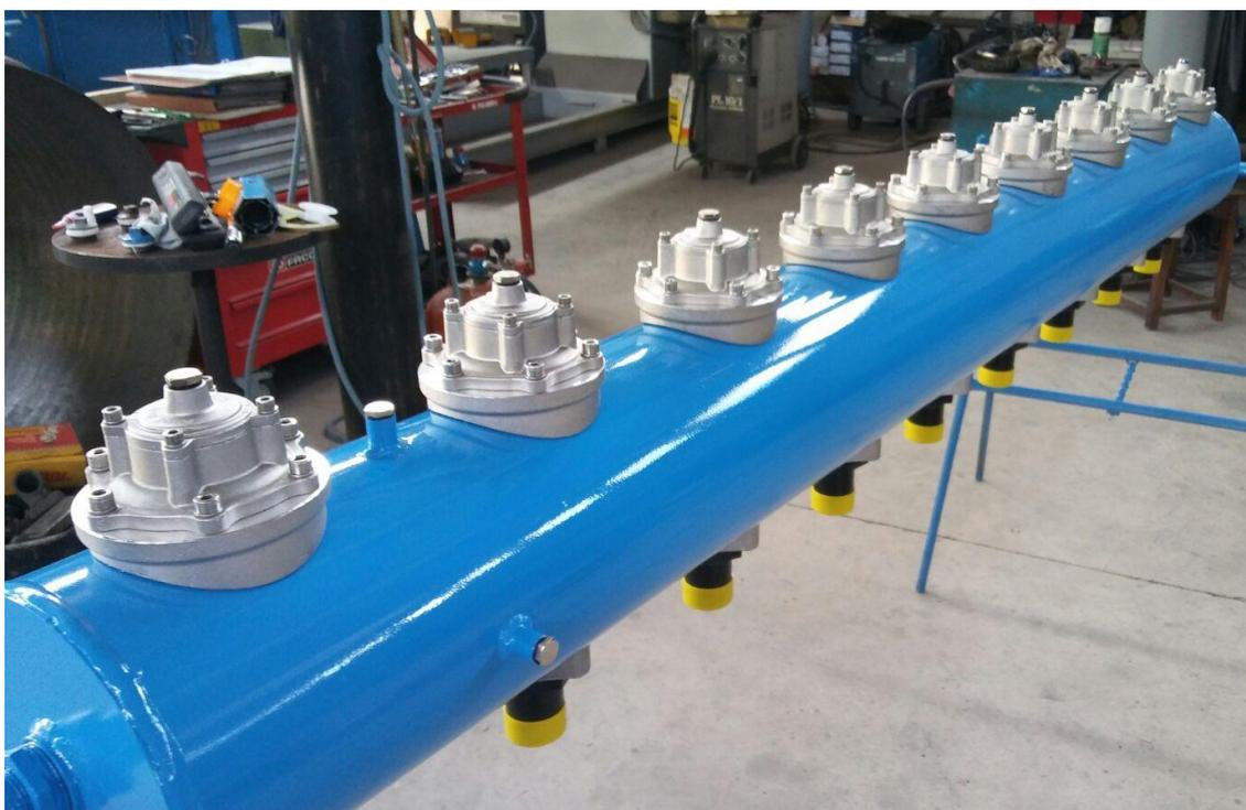
Figura 17. Colectores con válvulas neumáticas
