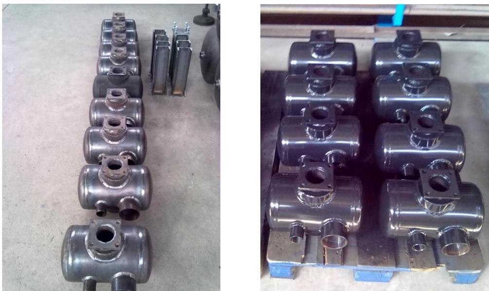
Figura 14. Silenciador de pulsaciones. La figura de la izquierda muestra el silenciador de pulsaciones sin acabado superficial, la figura de la derecha muestra el producto acabado.
